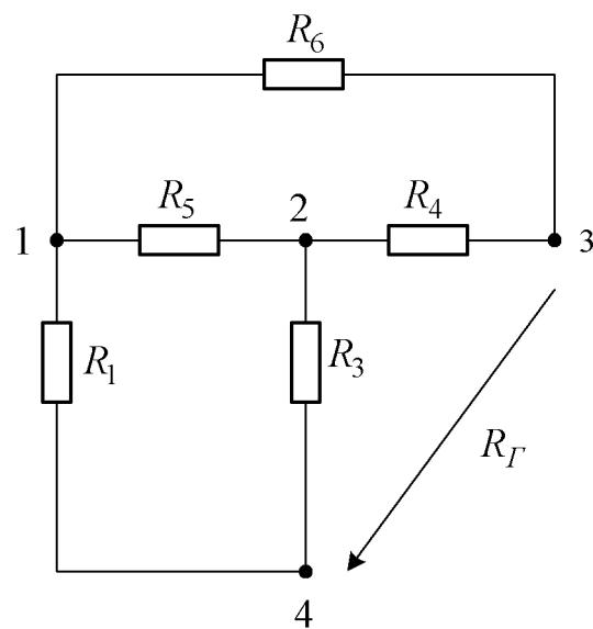
Упростим схему, преобразовав треугольник сопротивлений  $R_4, R_5, R_6$  в звезду сопротивлений:
